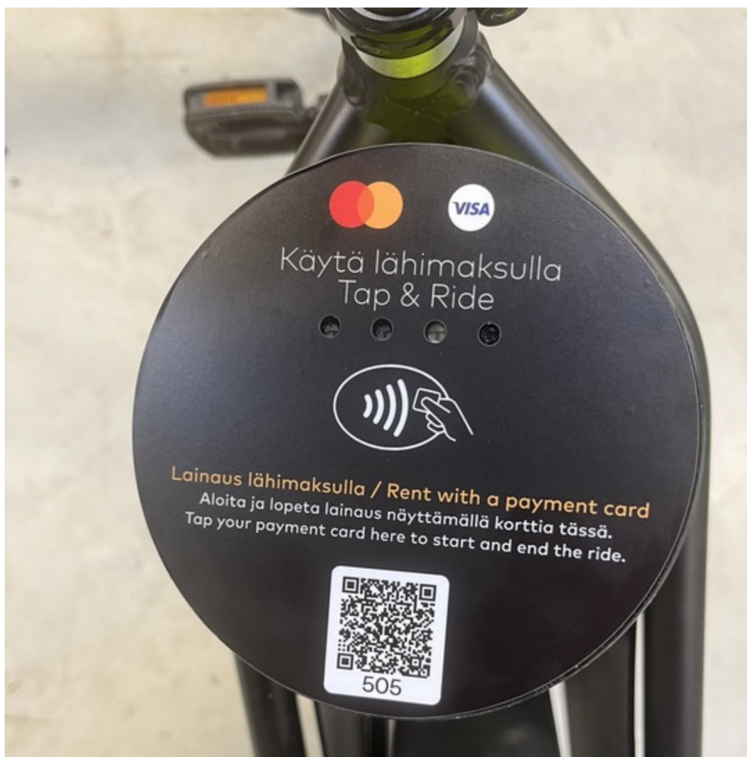
Terminál pro přiložení karty – bezkontaktní platba, terminal je umístěn na víčku boxu akumulátoru – za sedačkou
