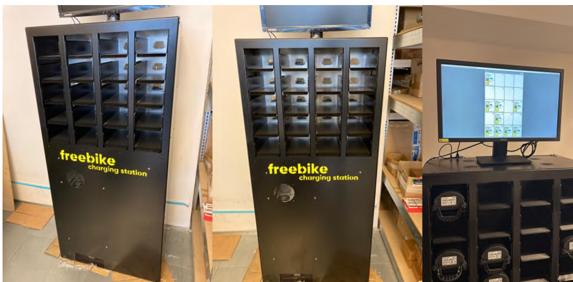
Dobíjecí stanice – monitor sleduje průběh a stav nabíjených baterií
