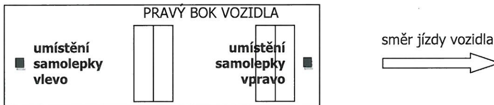
Obr. 3.2. Orientace umístění samolepek na vybraném boku, resp. čele vozidla.
